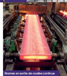
Brames en sortie de coulée continue
