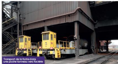
Transport de la fonte dans une poche tonneau vers l'aciérie
